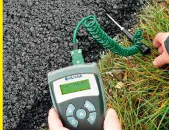
Nos enrobés basse température sont fabriqués à 120°C au lieu de 160°C et peuvent être mis en œuvre jusqu'à 100°C.
