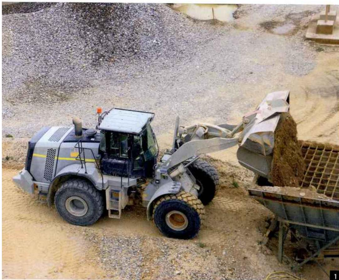
1/ Sur le site, la chargeuse Caterpillar 972K est connectée au pont-basculé grâce à un système développé en interne pour éditer automatiquement les bons de commande.
