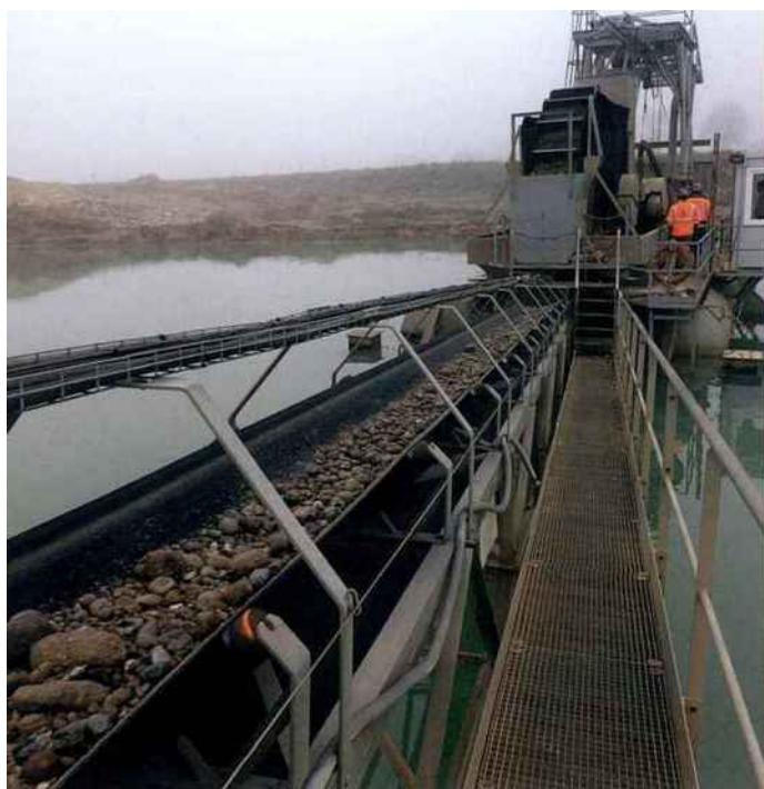
Le tout-venant est un 0/300 dont le D est limité par le tuyau de la drague flottante. Ce matériau sablo-graveleux est très siliceux, avec plus de 97 % de silice, et provoque de l'usure par le frottement dans les conduites.
