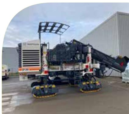
■ **SP 20 - SP 25**, nos SP permettent la mise en oeuvre et le coulage de tous types de bordures, murets, murs, fossés trapèze, cunettes, CAF, trottoirs, aires de béquillage de 2,50 mètres, piste cyclable largeur maximum 4 mètres.
