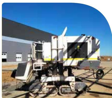
■ **MILERS 1000**, ces dernières permettent de couler des bordures et murets avec un faible encombrement permettant de réaliser des chantiers très étroits 2,5 m fil d'eau - fil d'eau) accompagnées d'un dumper pour l'alimentation béton. Son rayon de courbe est plus serré que celle des SP.
